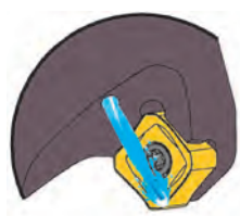
Внутренняя подача СОЖ при обработке аустенитной нержавеющей стали
